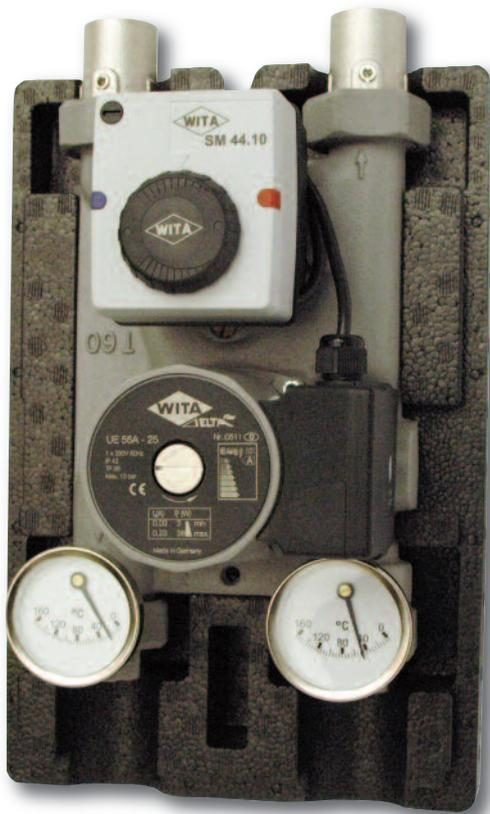
Der WITA-Bloc T60 ist eine aus Grauguss gefertigte Kompaktarmatur, die Umwälzpumpe, Mischer und bei Bedarf ein Überströmventil in einem Gehäuse vereint. Haupteinsatzbereich sind kleine und mittlere Warmwasserheizungen. Die Vorlaufrichtung ist bedingt durch die Drehrichtung der Pumpe, rechts.
